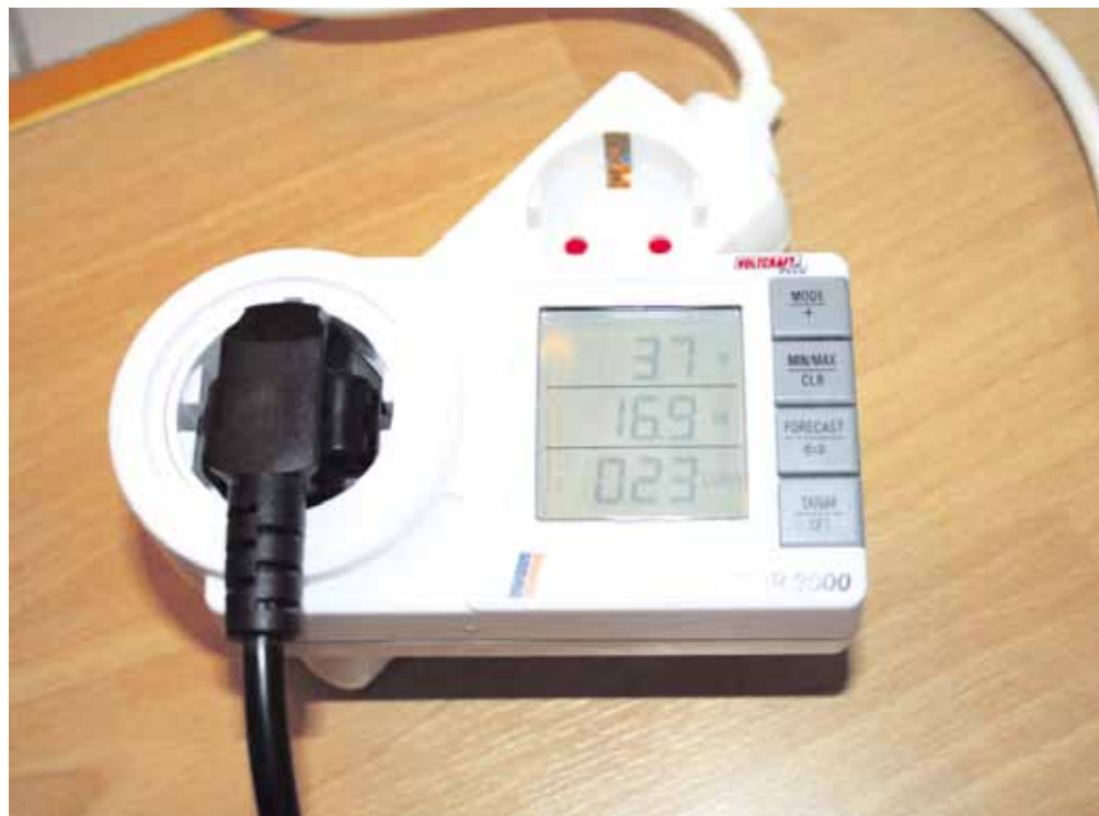
Messungen des «Schein-Aus» zeigen es klar: PC und Monitor verbrauchen auch Strom, wenn sie nicht eingeschaltet, aber angesteckt sind.
