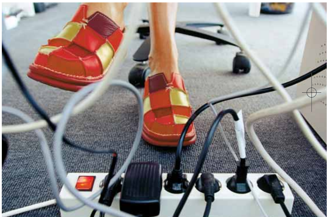
Steckerleiste: Mit dem Kippschalter lassen sich Geräte vollständig vom Stromnetz trennen
